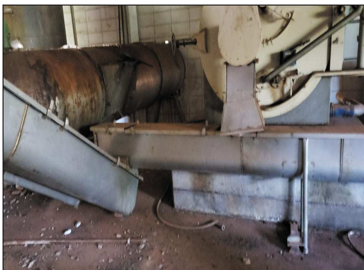
Produção – Transportadores helicoidais de inox.
