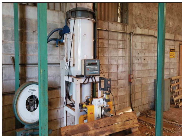
Envase – Balança Filizola e ensacadora SatParaná.
