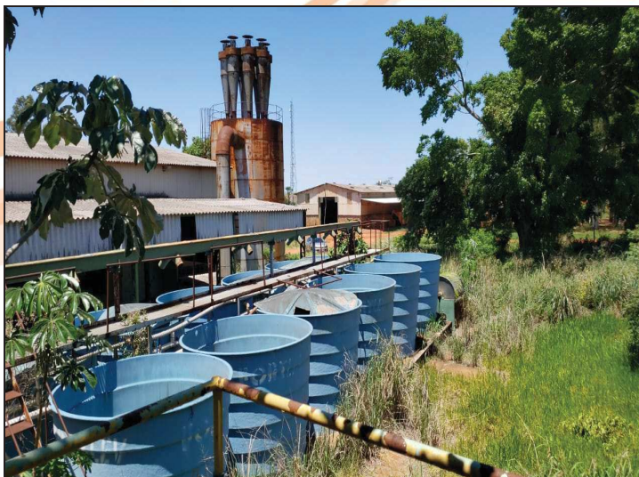
Produção – Tanques fibra 15.000 litros e transportador helicoidal.
