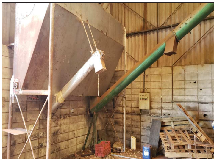
Envase – Silo ensaque 3 t com duas roscas.
