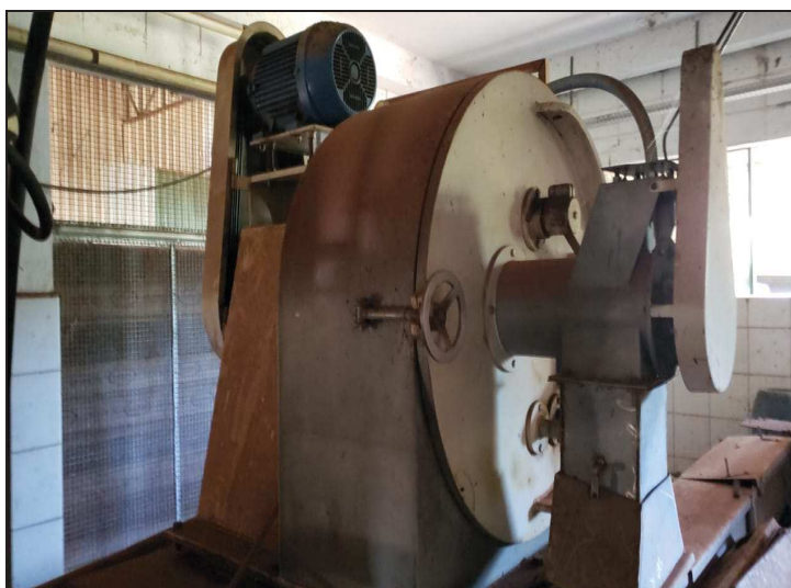
Produção – Desintegrador Piller.
