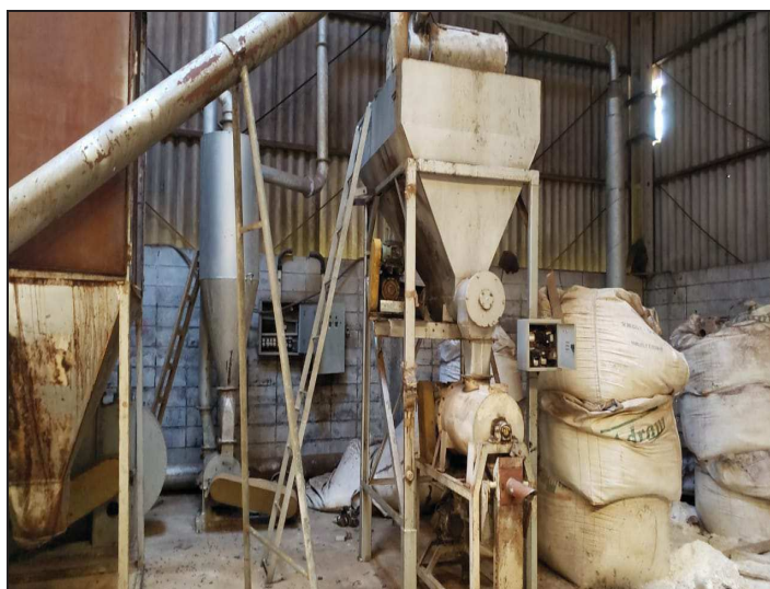
Envase – Aspirador de pó e classificador de amido seco.
