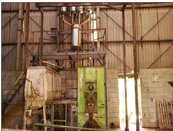
Envase – Misturadores Ribon Blender e Conjunto dosador de líquidos.
